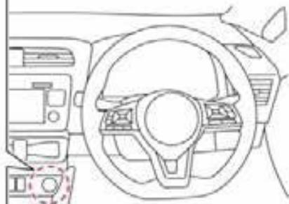
※ブレーキペダルを踏まずにパワースイッチを押したときは、走行可能表示灯は点灯せずにOFF⇒アクセサリ⇒ON⇒OFFの順番にモードが切り替わります。
